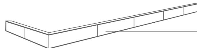
Ausführung als Werbeblende und über Eck möglich. Wobei die Fronten alle 3 Meter geteilt und mit Nut und Feder ausgestattet sind.
